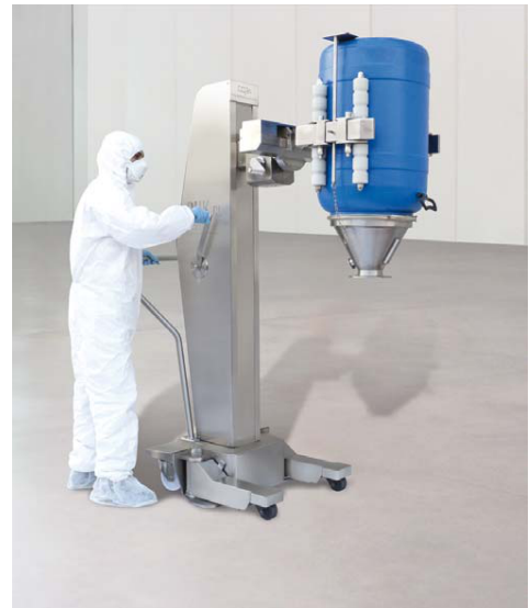
DUK CL mit angedocktem Behälter
